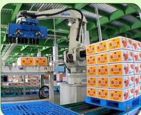
パレタイザー(左)で直接積み付けが可能となる底面補強資材を開発。
